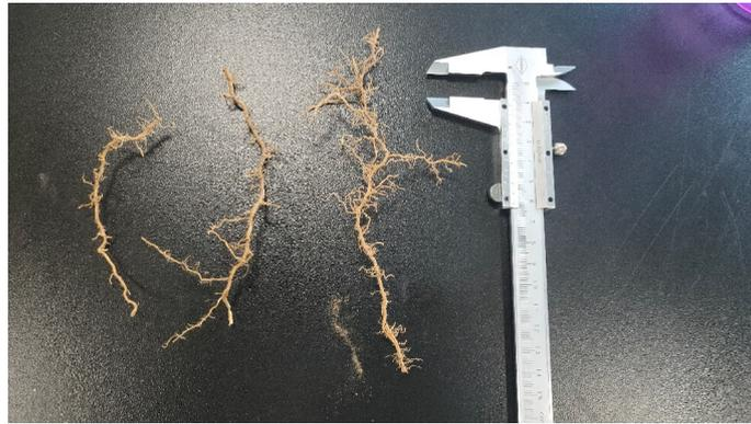
图 4 直接剪切试验使用的毛竹根系
