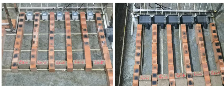
图1 潜水泵及封闭水道(部分)
