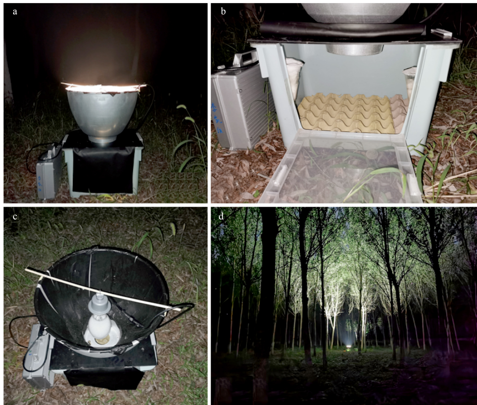
图 1 聚光灯诱箱(a)及其相关结构(b、c)与光路效果(d)
