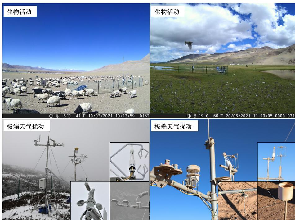
图 1 涡度协方差测量期间生物活动和极端天气扰动引起的异常测量
