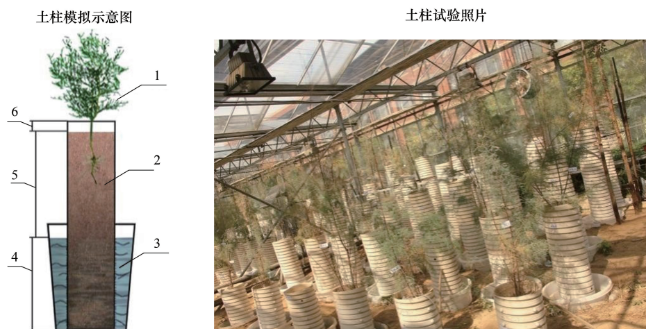
图 1 不同地下水位下栽植怪柳土柱的模拟示意图和实景图
