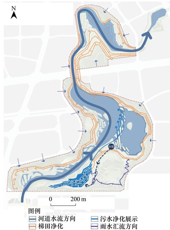
图8 美舍河生态修复的水过程设计图
