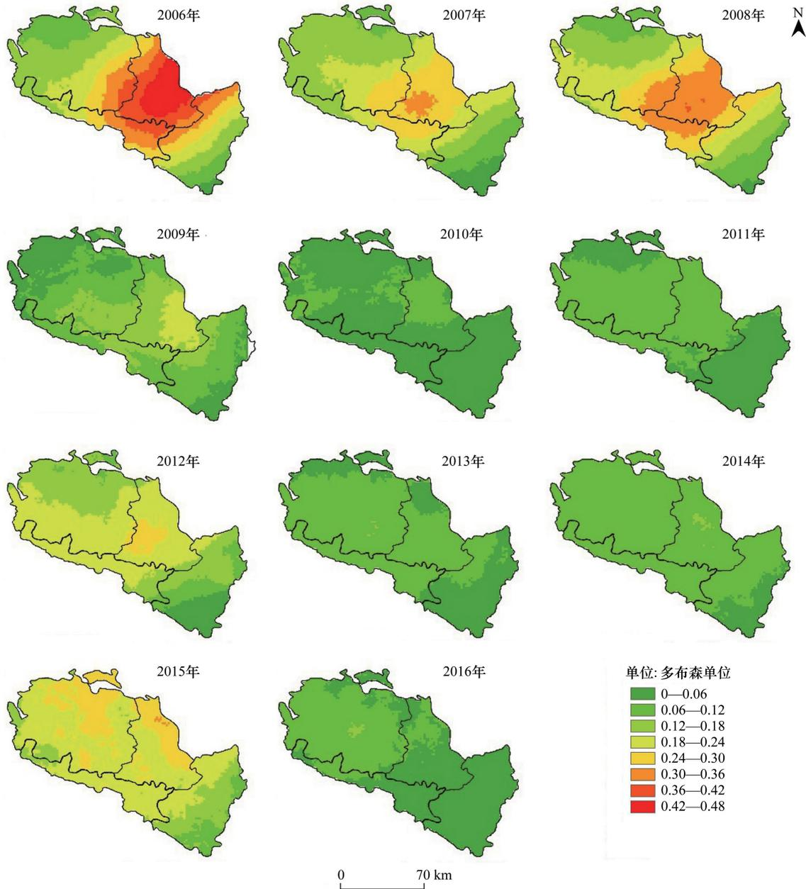
图3 对流层 SO<sub>2</sub>柱浓度年平均值空间分布图/(多布森单位)
