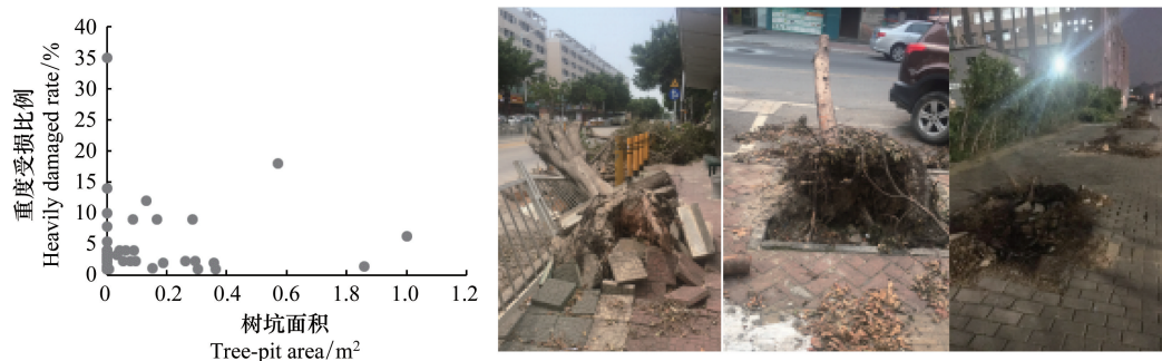
图5 行道树树坑面积与其受损程度之间的关系;树坑较小的行道树被连根拔起
