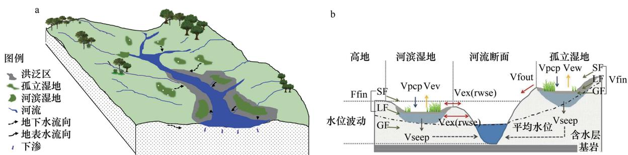
图2 流域水文连通性概念模型
