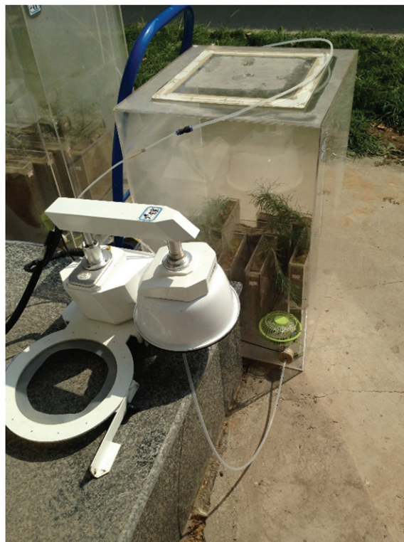
图 1 双层密闭有机玻璃标记气室
