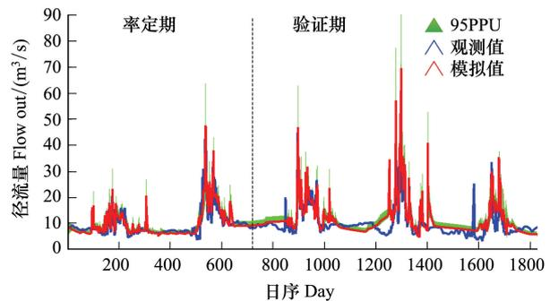
图 10 CMDAS 数据集驱动 SWAT 模型的温泉控制站逐日模拟结果(2009—2013),其中,95PPU 代表预测不确定性内监测数据占据的百分比
