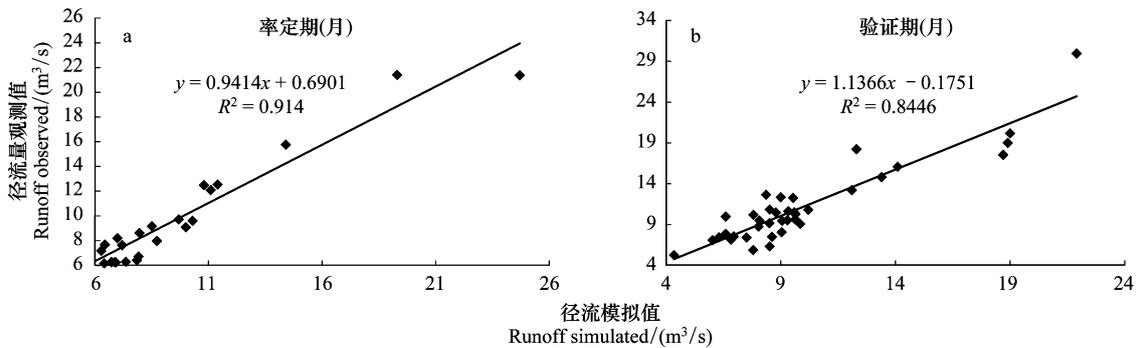
图 7 温泉控制站月站点观测与模式模拟结果确定性系数
