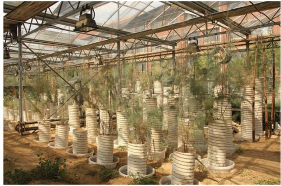
图 1 柽柳土柱模拟装置实景图
