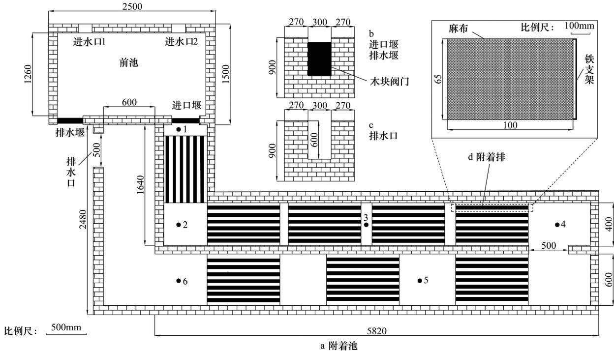
图 1 附着池结构及采样点设置示意图
