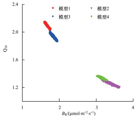
图 3  $B_R$  和  $Q_{10}$  的最优参数集散点图
