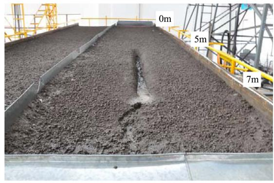
图 2 沟蚀试验处理(有锥型沟)
