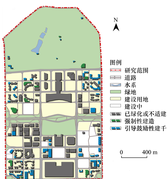
图6 深圳市中心区屋顶绿化建造措施
