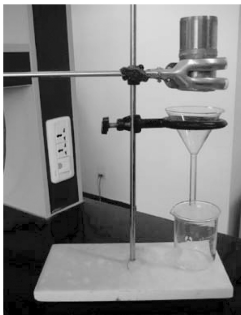
图 1 环刀法测量土壤入渗
