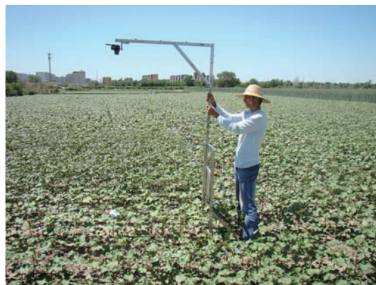
图 1 棉花冠层图像便携式采集架田间观测示意图
