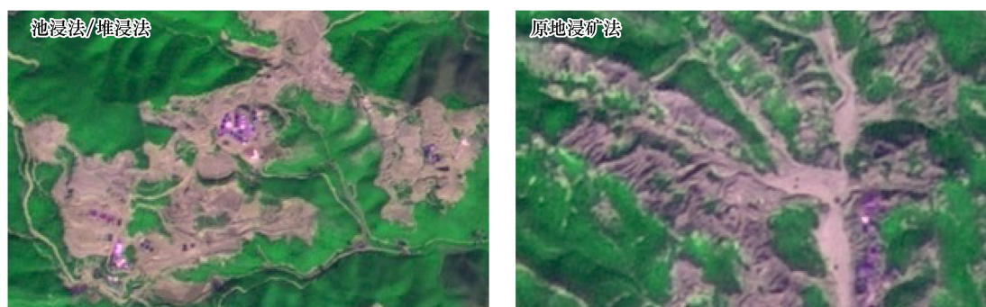
图 1 稀土矿开采区 ALOS 遥感影像(左图:池浸法/堆浸法;右图:原地浸矿法)
